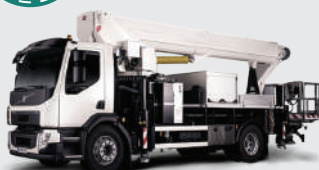
Camión plataforma elevadora.
