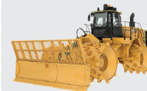
Compactador de Aterro.
